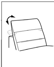
Einzel verstellbares Kopfpolster mit Rasterfunktion und Faltoptimierung.
