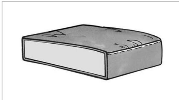
Rücken: Schaumstoff bedeckt mit geflocktem Schaum und einer Silikonmischung
