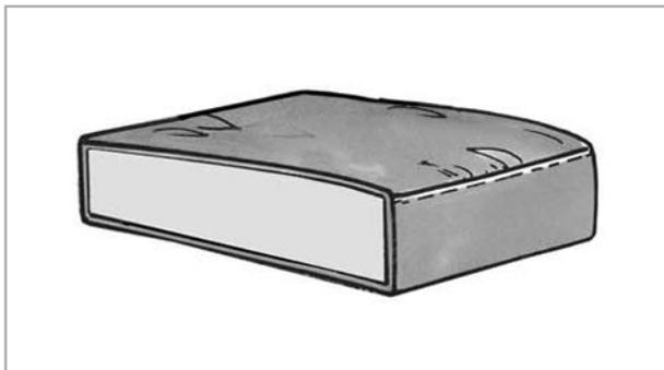
Sitz: Der Sitz ist gefüllt mit HR-3538 Polyurethanschäum, 35 kg/m<sup>3</sup> Raumgewicht, Stauchhärte 38
