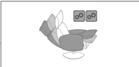
2-motorische Verstellung mit getrennter Sitz- und Rückenverstellung. Bedienung per Handschalter (mit Magnet am Armteil gehalten).
