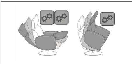
3-motorische Verstellung mit getrennter Sitz-/Rückenverstellung und Aufstehhilfe. Bedienung per Handschalter (mit Magnet am Armteil gehalten).
