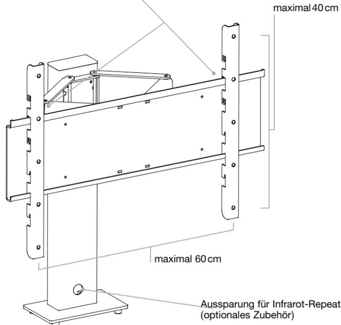
Arm um bis zu maximal 80° schwenkbar (abhängig von der Fernsehgröße)
