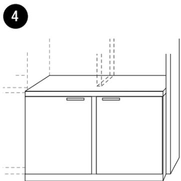
**4** Vorsatzwange (dient dem Breitenausgleich von Korpus-elementen bei Wangenplanungen) mit durchgehendem Abdeckblatt und Sockelleiste
